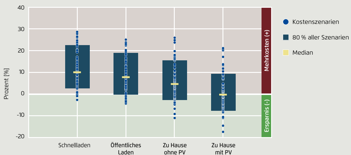
Gesamtkosten von vollelektrischen Pkw im Verhältnis zu den Gesamtkosten vergleichbarer Verbrennerfahrzeuge bei mittleren Preisen nach Ladeprofil bei fünf Jahren Haltedauer Abbildung 11
