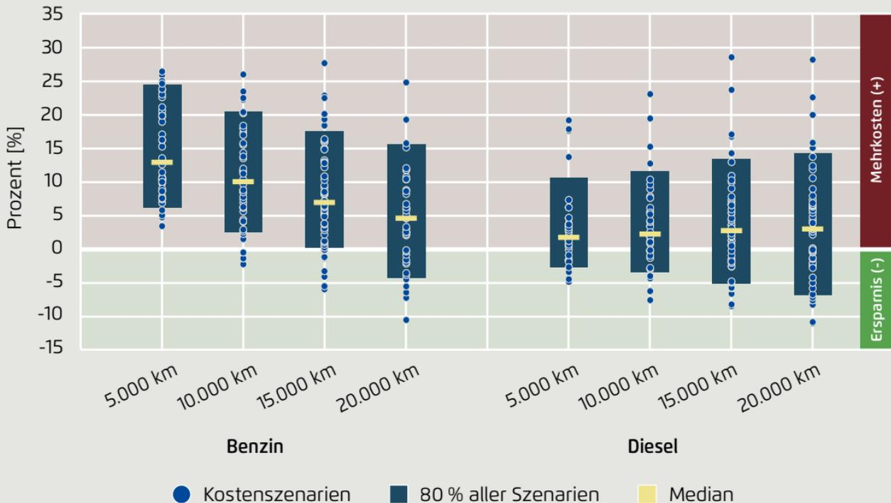
Die Abbildung zeigt die Ersparnis (negative Ergebnisse) oder Mehrkosten (positive Ergebnisse) des E-Pkw aller gerechneten Modell- und Szenariokombinationen bei rein öffentlichem Laden und bei unterschiedlicher Jahresfahrleistung getrennt nach Kraftstoffarten.
